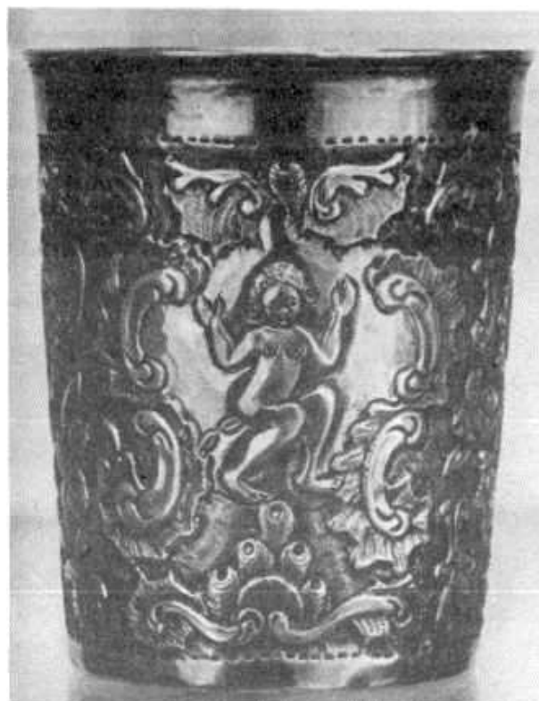
51. Контурная чеканка с проработкой фона и применением фактурных чеканов
